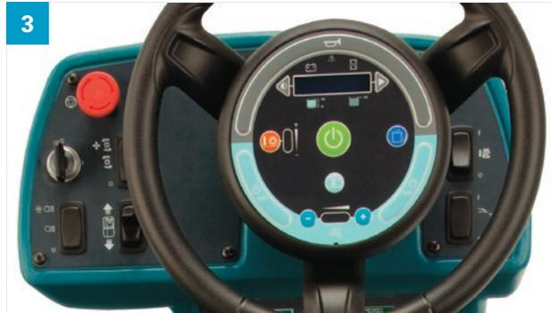
**3. Module de commandes Touch-n-Go™ avec bouton 1-Step™** – rehaussez la sécurité avec des commandes intuitives situées juste devant l'opérateur, éliminant ainsi le besoin de retirer les mains du volant pour changer les réglages de récurage.
